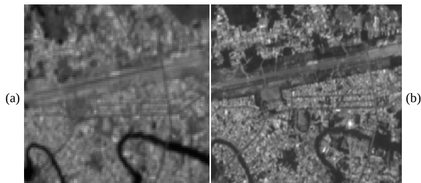
Hình 3: Kết quả Pan-Sharpning ảnh Sentinel-2. (a) Kênh 11 trước Pan-Sharpning; (b) Kênh 11 sau Pan-Sharpning.
