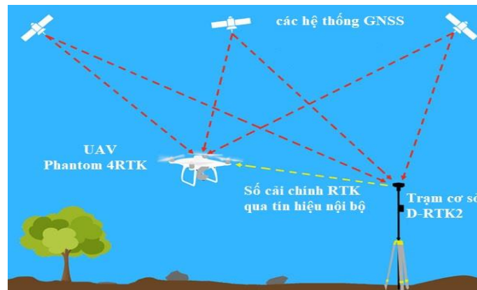
Hình 3. Phương pháp định vị tâm chụp cho UAV bằng RTK với trạm cơ sở đồng bộ D-RTK2 (nguồn: Escadrone.com, 2020).
