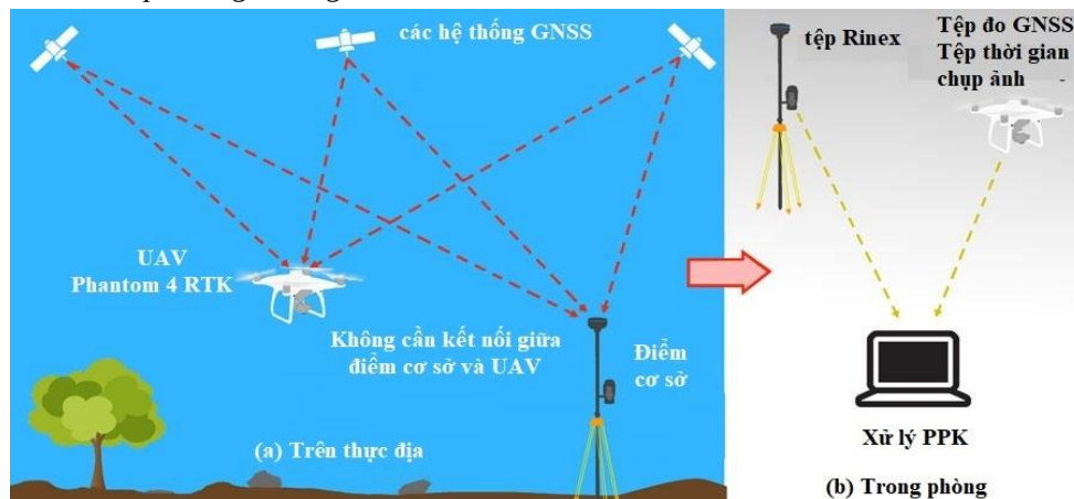
Hình 4. Phương pháp định vị tâm chụp cho UAV bằng PPK (nguồn: Escadrone.com, 2020).
