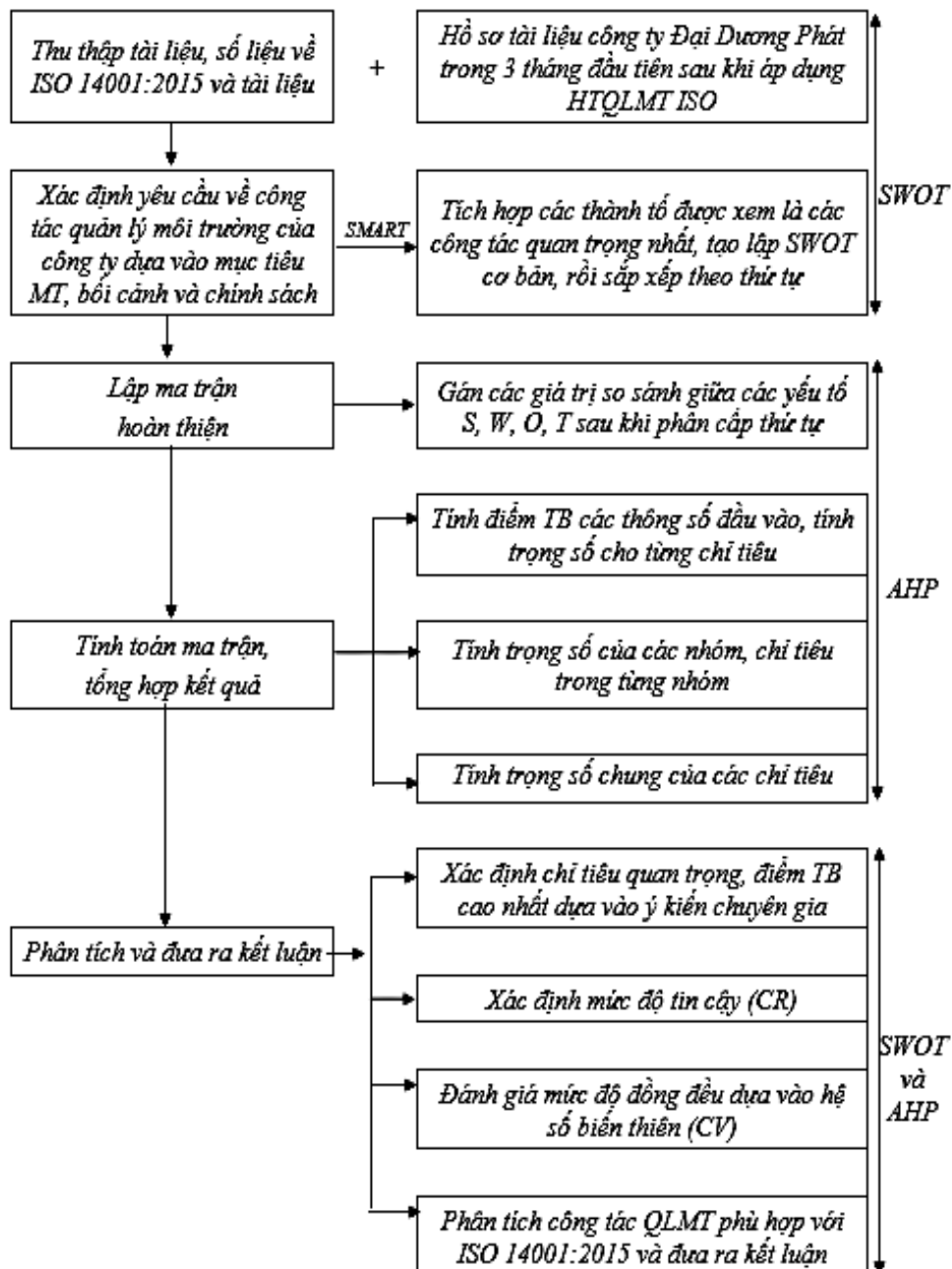
Hình 1. Quy trình thực hiện chi tiết phân tích AHP dựa trên SWOT
