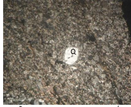
Hình 3. Mẫu TL13/1-Đá ryolit porphyr, cấu tạo khối, kiến trúc nổi ban, kiến trúc nền hạt nhỏ. Nicol +.
