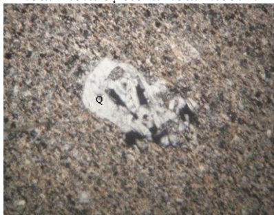
Hình 14. Mẫu TL40. Ban tinh thạch anh méo mó, khoáng vật nền định hướng. Nicol +.
