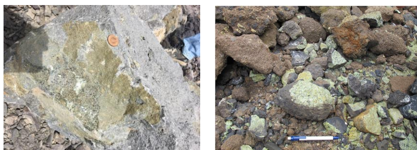
Hình 1. Thể sót lherzolite spinel tại mỏ đá Đất Đỏ (trái) và Ia Băng, Pleiku (phải) kích thước thể sót đến 10x20x30 cm
